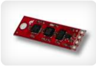
Abbildung 3 9 DOF Sensor Stick
